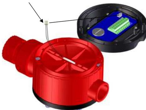
Die 4 Torx-Schrauben herausdrehen (Anzugsmoment max. 0,5 Nm).
