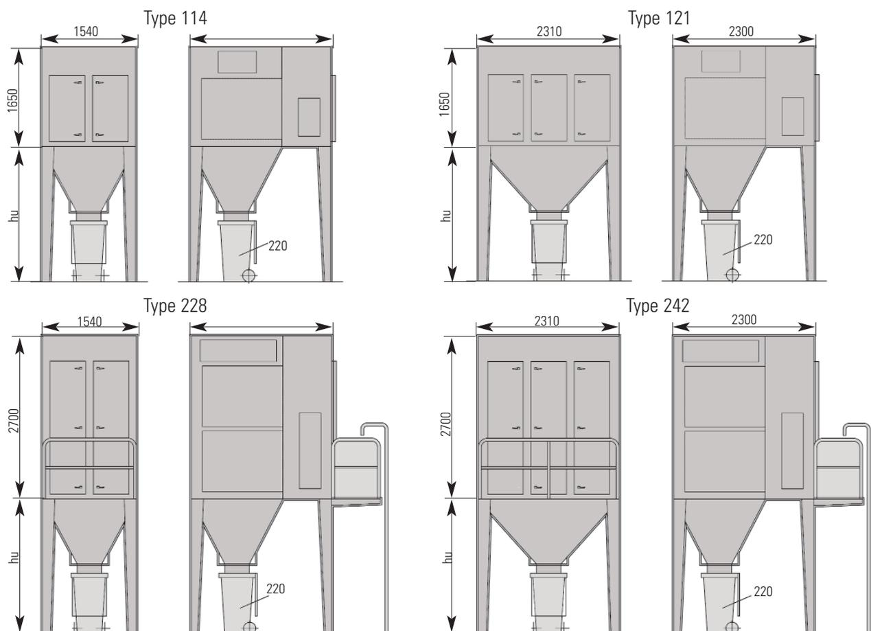
hu=2000mm ; support standard pour raccordement à un bac de récupération de 220L
