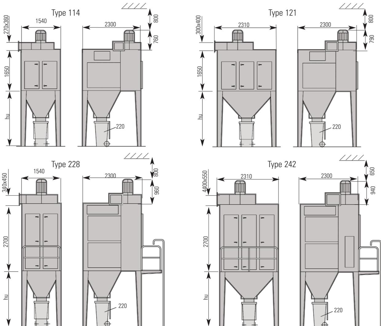
hu=2000mm ; support standard pour raccordement à un bac de récupération de 220L
