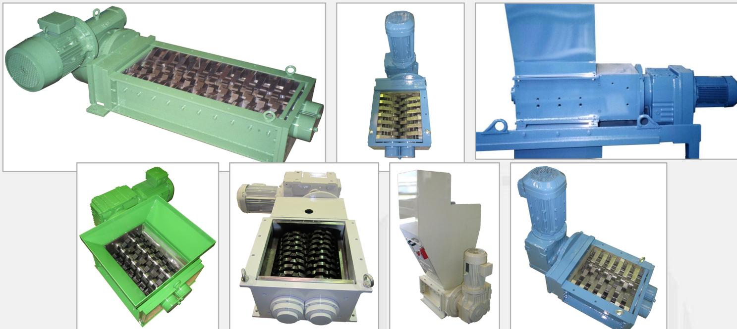
Utilisé pour la réduction de volume ou le calibrage de copeaux métalliques, le broyeur a une série de couteaux montés sur deux arbres parallèles avec sens de rotation inverse et vitesses différentes.
