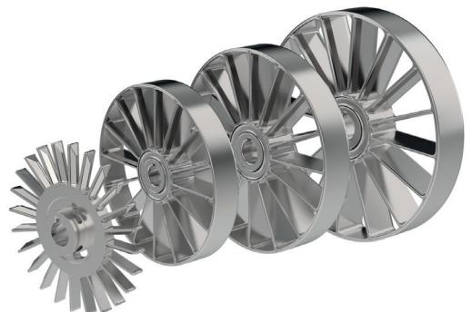
Giranti stellari in CF-3M 1.4404 / AISI 316L realizzate con procedimento di microfusione.
