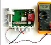
Cette fonction permet de vérifier sur un multimètre, sur un régulateur/afficheur, ou sur un automate le bon fonctionnement des sorties. Le capteur va générer une tension de 0 V, 5 V et 10 V ou un courant de 4 mA, 12 mA et 20 mA.
