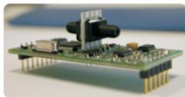
La carte SPI (Sonde de Pression Interchangeable) intègre un élément sensible de type piézorésistif ainsi que son électronique numérique. Ce système, ajusté individuellement, intègre tous les paramètres d'étalonnage. Automatiquement reconnue par le capteur cette carte numérique est totalement interchangeable. Elle facilite grandement la maintenance, le service et l'étalonnage des capteurs sans immobiliser l'ensemble de la chaîne de mesure lors d'interventions.
