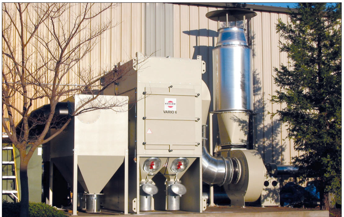
VARIO 6 avec préséparateur de copeaux et ventilateur équipé d'un silencieux de refoulement
