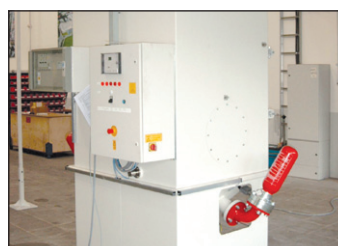
Suppression d'explosion par injection automatique d'agent d'extinction
