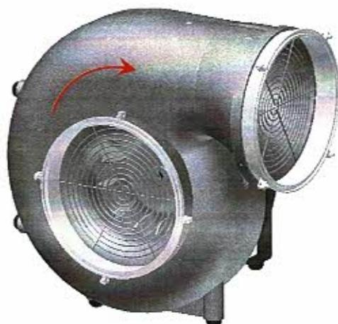
Moteur à air comprimé : régler l'appoint à environ 5 gouttes d'huile par minute en service continu et à 10 en service intermittent.
