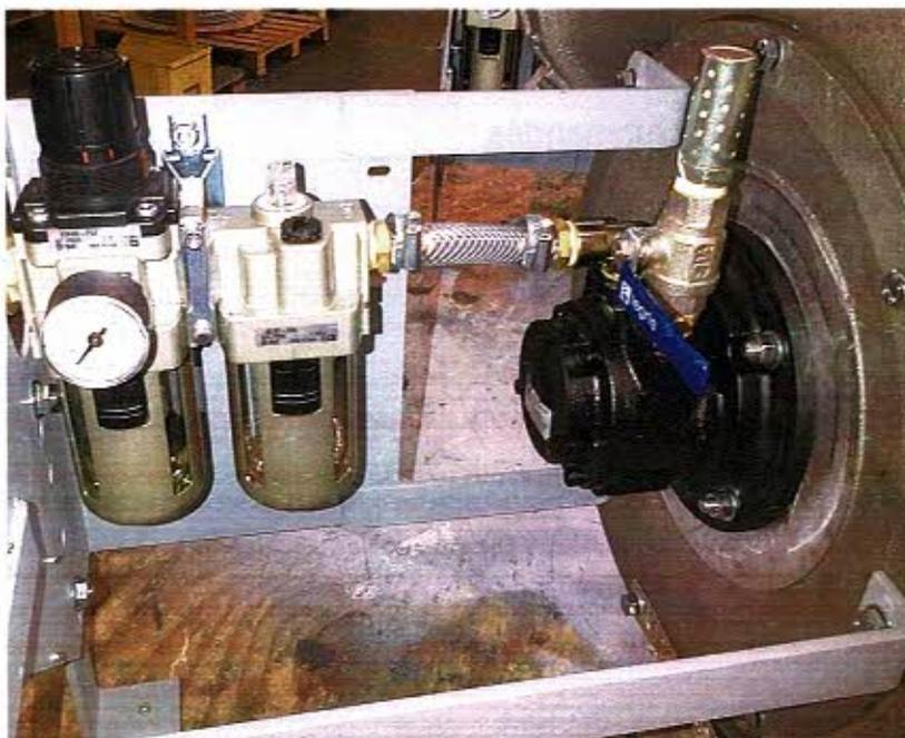
Pour tourner dans le sens de rotation correct, l'alimentation en air comprimé doit se faire par l'orifice taraudé 1/2" situé au-dessus et à gauche, vu côté arrière du moteur suivant flèche.
