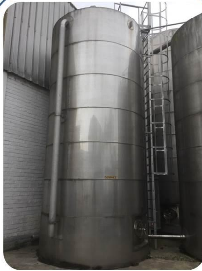
(x2) HOLVRIEKA - 30m 3 – 300 HL Inox 316L - Calorifugée
