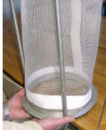
Emboîtement du nylon sur son ossature, en faisant attention au sens de la flèche indiquée sur ce nylon
