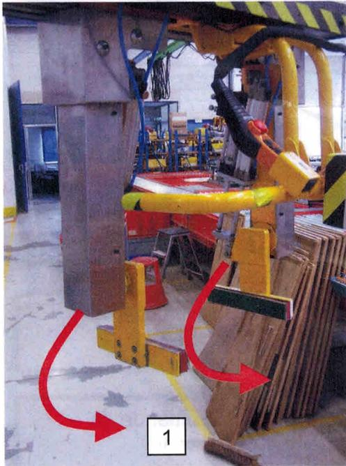
opérer une rotation des pinces du robot avec la commande du boîtier pneumatique.
