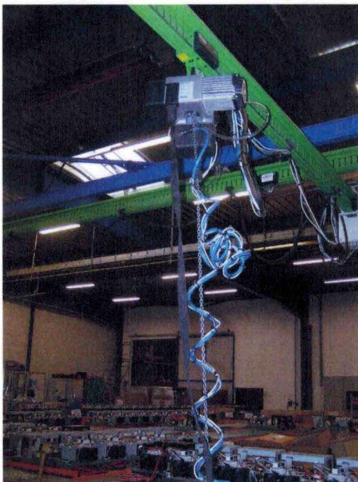
Vérifier que les cordons et tuyau ne s'enroulent pas autour du câble de levage.
