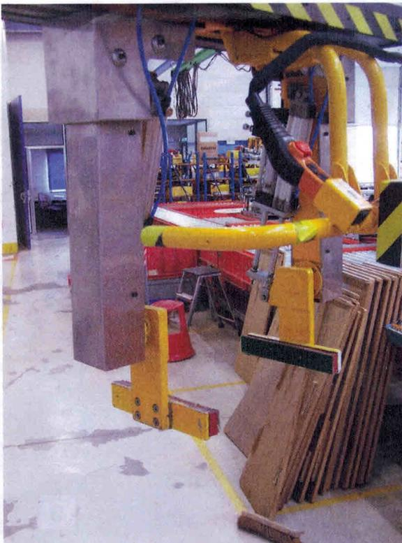
Lever le robot au niveau de la chaîne.
