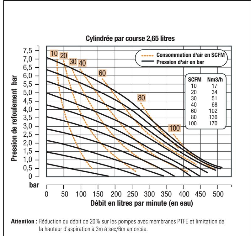
**Attention ! Ne pas dépasser la pression de 8,5 bar d'alimentation d'air ou de contre-pression au refoulement.**
