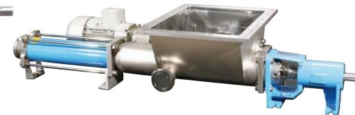
Employées pour pomper des produits visqueux et délicats, abrasifs ou contenant des boues en suspension, les pompes volumétriques sont réputées pour leur polyvalence. Fabrication en plusieurs exécutions en acier AISI 304, 316 ou fonte, selon les utilisations. Débits de m<sup>3</sup> 0,3 à 130 m<sup>3</sup>/h, hauteurs de l à 24 bar.
