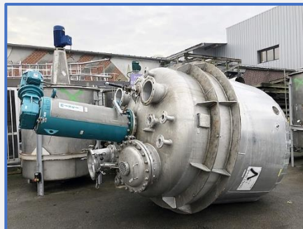
CICR – Réacteur 7000 LITRES Inox 316L, ½ coquille Grade 316L, half coil jacket
