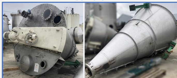
NAUTAMIX 6000 LITRES - Type 60-MFC-45 Conique à vis / Screw Conical
