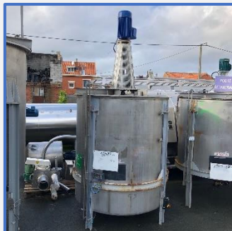
3 CUVES DE 4500 LITRES Inox, agitées S/S agitated
