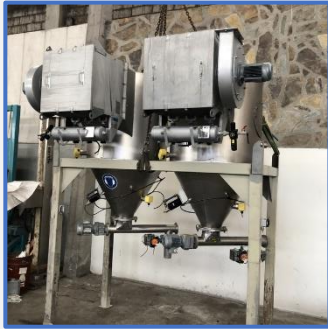
2 trémies avec vis & dépoussiéreur 2 hoppers with screw and dust filter
