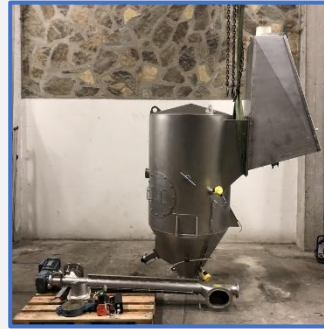
Trémie vide sac avec vis Sack discharging with hopper and screw
