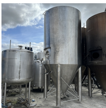
3 cuves type fermenteur KASPAR SCHULTZ 8714L S/S fermentation tanks
