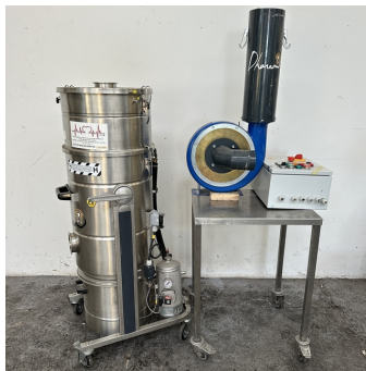
3 séparateurs filtrants inox PHARAON S/S mobile separators
