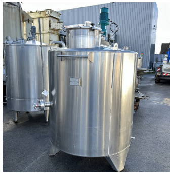
Cuve inox agitée 3400 litres CHALVIGNAC S/S agitated tank
