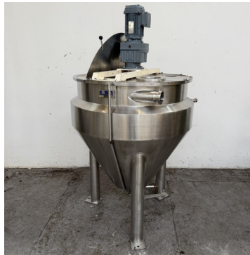
2 fondoirs inox 400 litres FRYMA S/S melting tanks
