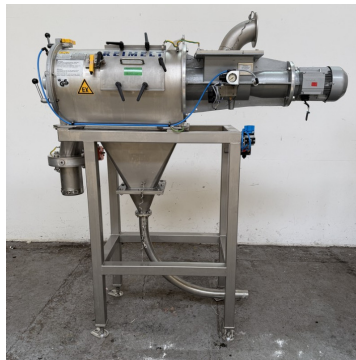
2 tamis centrifuges inox REIMELT type RS3 S/S centrifuge sifters
