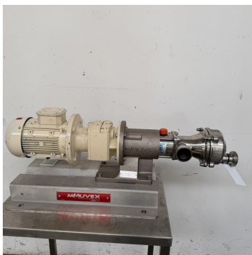
Pompe à piston excentré inox MOUVEX type SLS2 S/S eccentric disc pump
