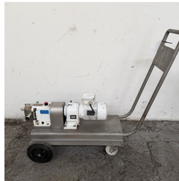
Pompe volumétrique à lobes inox INOXPA type SLR-1-25 S/S rotary lobe pump
