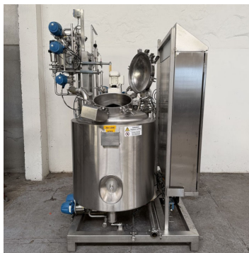
3 cuves agitées 463 litres double enveloppe CSC S/S double wall mixing tanks
