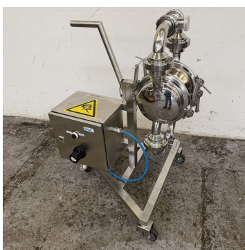
Pompe inox à membranes 1,5 pouce S/S diaphragm pump
