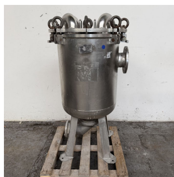
Filtre à 4 poches GAF type RB-4ASL S/S bag filter
