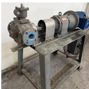
Pompe volumétrique inox à palettes BLACKMER type SNP2 Rotary vane pump
