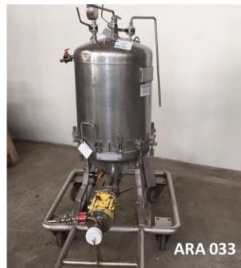
Filtres à plaques / Lenticular filter EUROFILTEC type FC450AC
