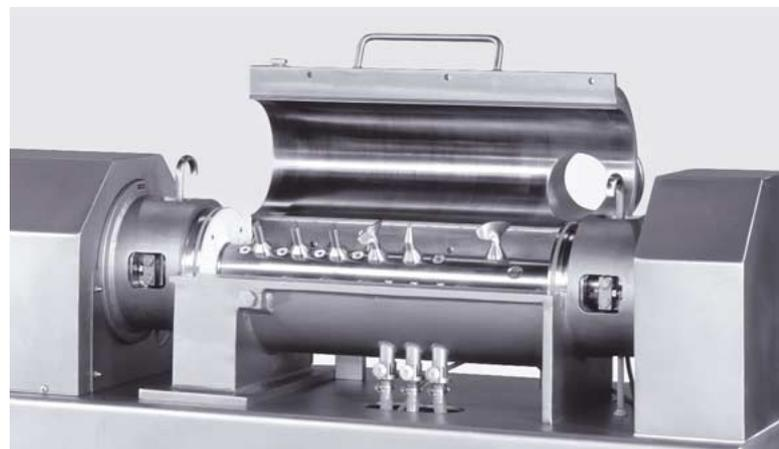
**Mélangeur continu à grande vitesse de rotation CoriMix® en version pharmaceutique pour humidification et granulation primaires. La partie supérieure s'ouvre sur toute la longueur du tambour.**
