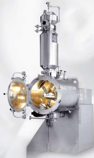
Sécheur sous vide avec pales spéciales
